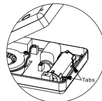
3. Soulever la petite carte électronique qui retient l'écran cible et l'ampoule (Assemblage d'ampoule) aux deux languettes.
