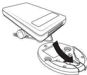
1. Une fois l'appareil assemblé et le socle monté, fixer simplement le support en fil de fer dans le socle. Le loquet à l'avant du socle doit s'enclencher, ce qui verrouille le support et l'appareil.
