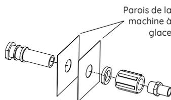
6. Coupez 5" (1,5 m) de tuyau et fixez-le sur la partie inférieure de l'appareil. Installez le diviseur sur le tuyau.
