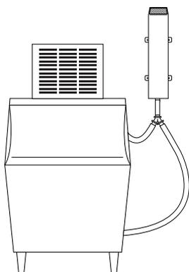
7. Coupez le reste du tuyau à la taille appropriée, raccordez-le au diviseur et insérez les deux raccords de cloison dans la machine à glace.
