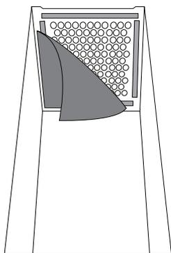
3. Installez les bandes Velcro sur la grille d'aération intérieure, juste à côté des trous. Fixez le préfiltre facultatif en appuyant fermement son côté lisse sur le Velcro.
