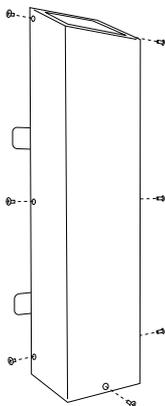
1. Retirez les trois (3) vis sur chaque côté de l'appareil et une (1) vis sur la partie inférieure du cache avant.
